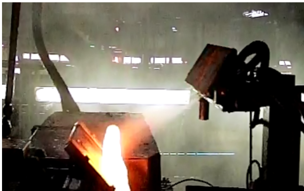
Rysunek 1.3: Odrzutnik kropeł. Zdjęcie wykonane przez autora w Hucie Szkła Orzesze
